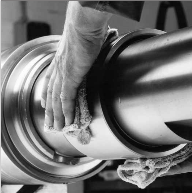
41: Un ligero movimiento de giro facilita el proceso al calar rápidamente las piezas de rodamientos calientes sobre el eje hasta que topen.
