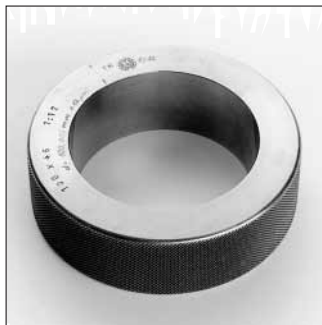
10: Los asientos cónicos pequeños se controlan con un anillo-calibre cónico.
