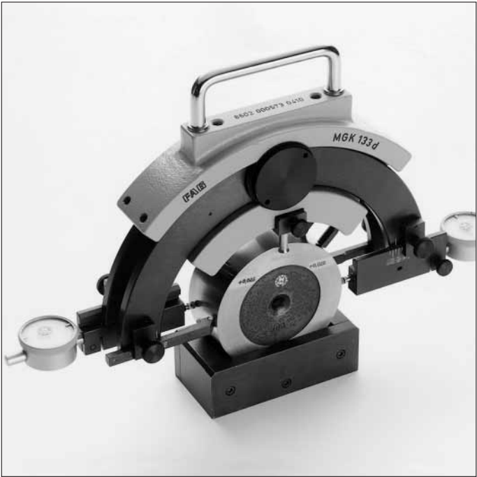
Los conos de longitud inferior a 80 mm se miden con el aparato de medición FAG MGK 133 (fig. 11).
