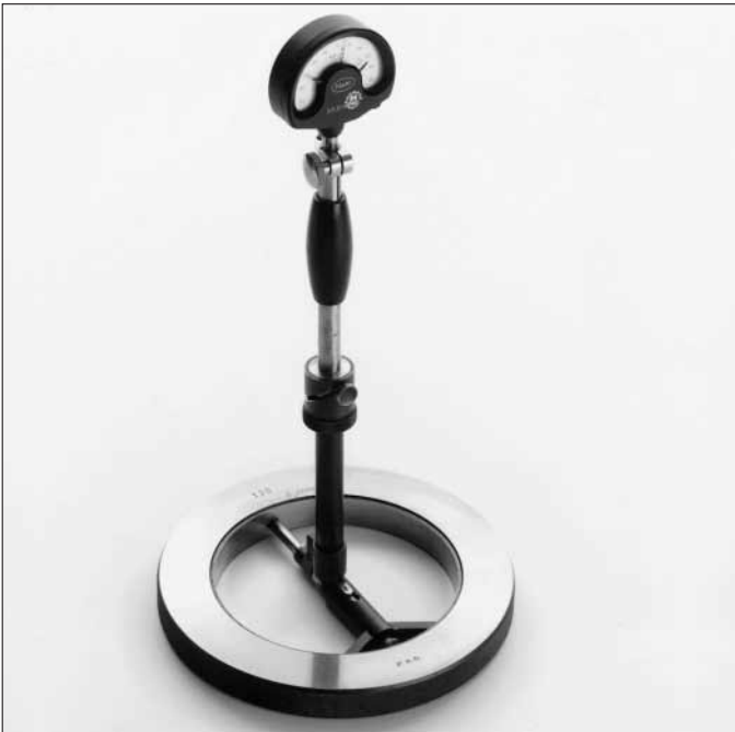
5: Para la medición de agujeros se utilizan sobre todo instrumentos de comparación. El arco-calibre mostrado se utiliza para la regulación.
